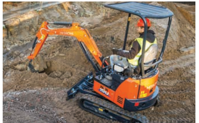
Il tettuccio a tre montanti aumenta la visibilità.
